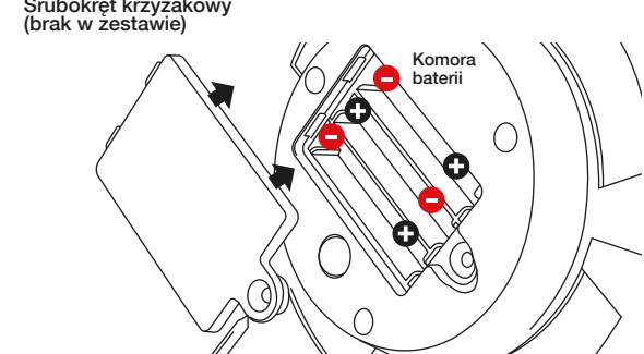
Otwórz pokrywę komory na baterie i dokładnie przykręć ją z powrotem po włożeniu baterii.
