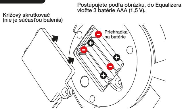
Otvorte kryt priehradky na batérie, vložte do nej batérie a následne ho pevne zaskrutkujte.
